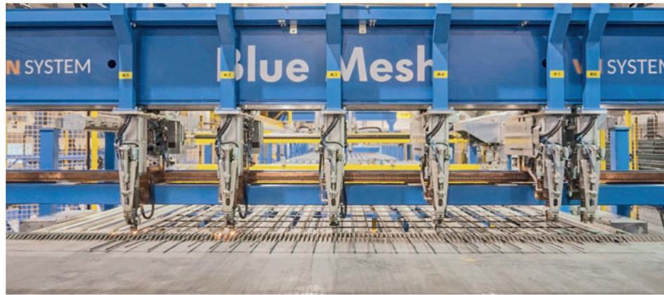
Гибкая система сварки арматурной сетки производит необходимую арматуру для производства точно в срок и в точном соответствии со спецификациями CAD
