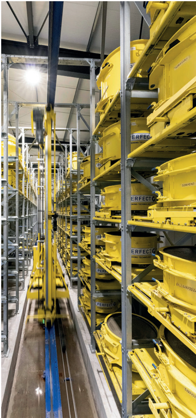
Многоярусные стеллажи для выдерживания бетонных элементов эффективно экономят пространство
