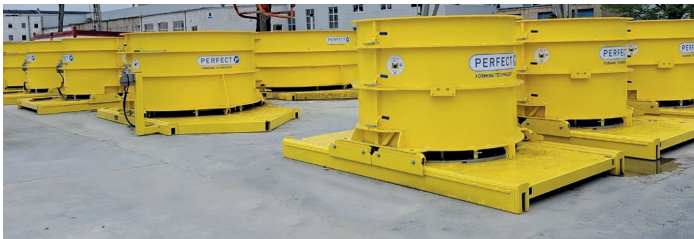
Koncept Perfect Forming Technology zastosowany do produkcji wyrobów do średnicy nominalnej 3 000 mm.
