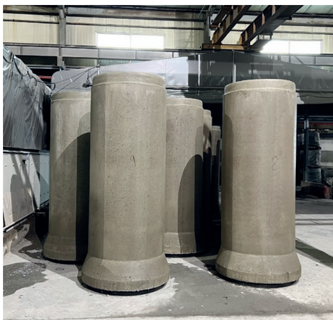
Rozformowane rury betonowe DN 1000.
