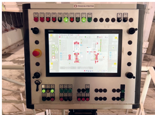
Innowacyjny internetowy system gromadzenia i wizualizacji danych Karajan z przeglądem najważniejszych informacji i danymi produkcyjnymi maszyny w czasie rzeczywistym.
