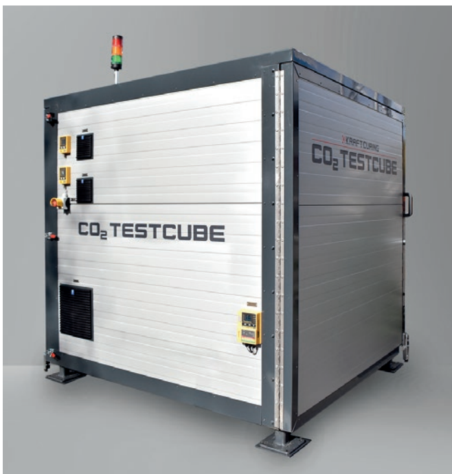
CO 2 TestCube firmy Kraft umożliwia przetestowanie różnych scenariuszy sezonowania wyrobów.
