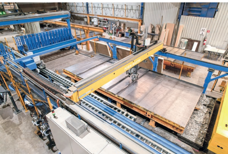
Robot szalunkowy Form Master rozmieszcza i usuwa szalunki w pełni automatycznie i precyzyjnie zgodnie z danymi CAD.
