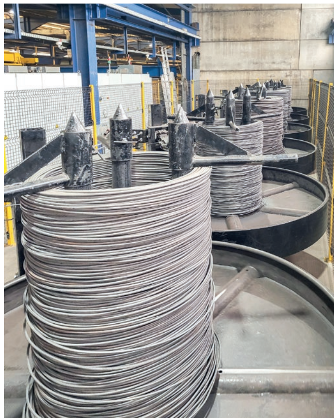
Maszyny do obróbki zbrojenia wykorzystują stal podawaną z kręgów, więc pozwalają uniknąć odpadów.
