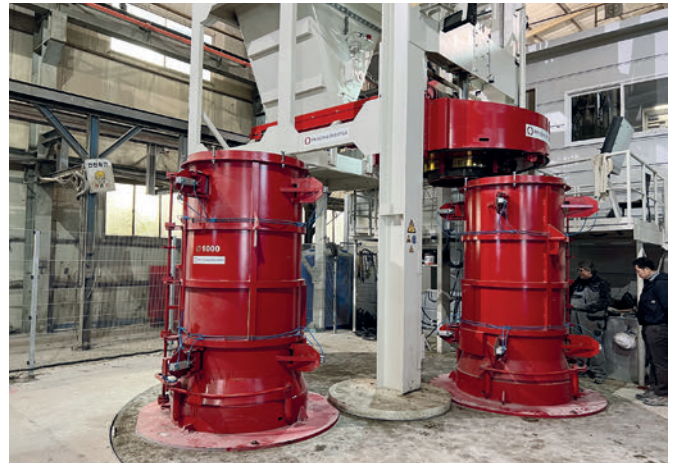
Produzione di tubi con due stampi
