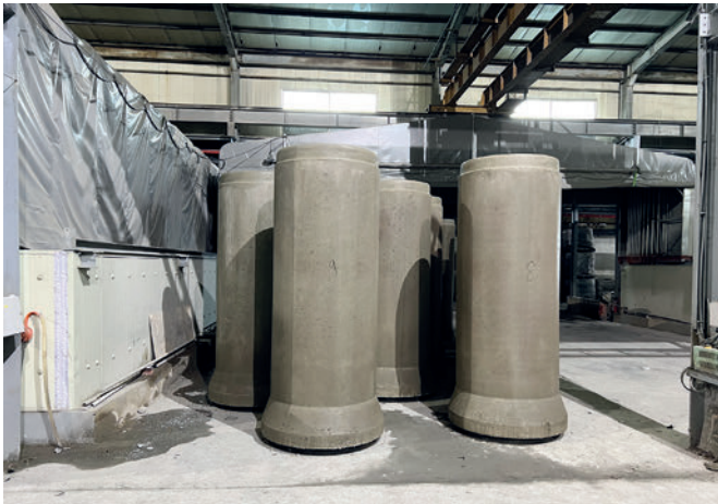
Tubo in calcestruzzo disarmato DN 1000
