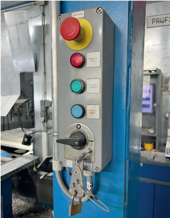
*Sicura e pratica: sistema lockout-tagout per la manutenzione*
