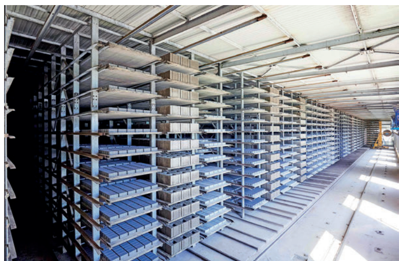
Bien coordonné et résolu individuellement : logistique d'entrée et de sortie dans le domaine du durcissement
