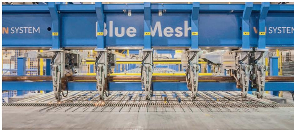
El sistema de soldadura de malla flexible produce el refuerzo necesario para la producción al momento y con precisión según las especificaciones CAD.
