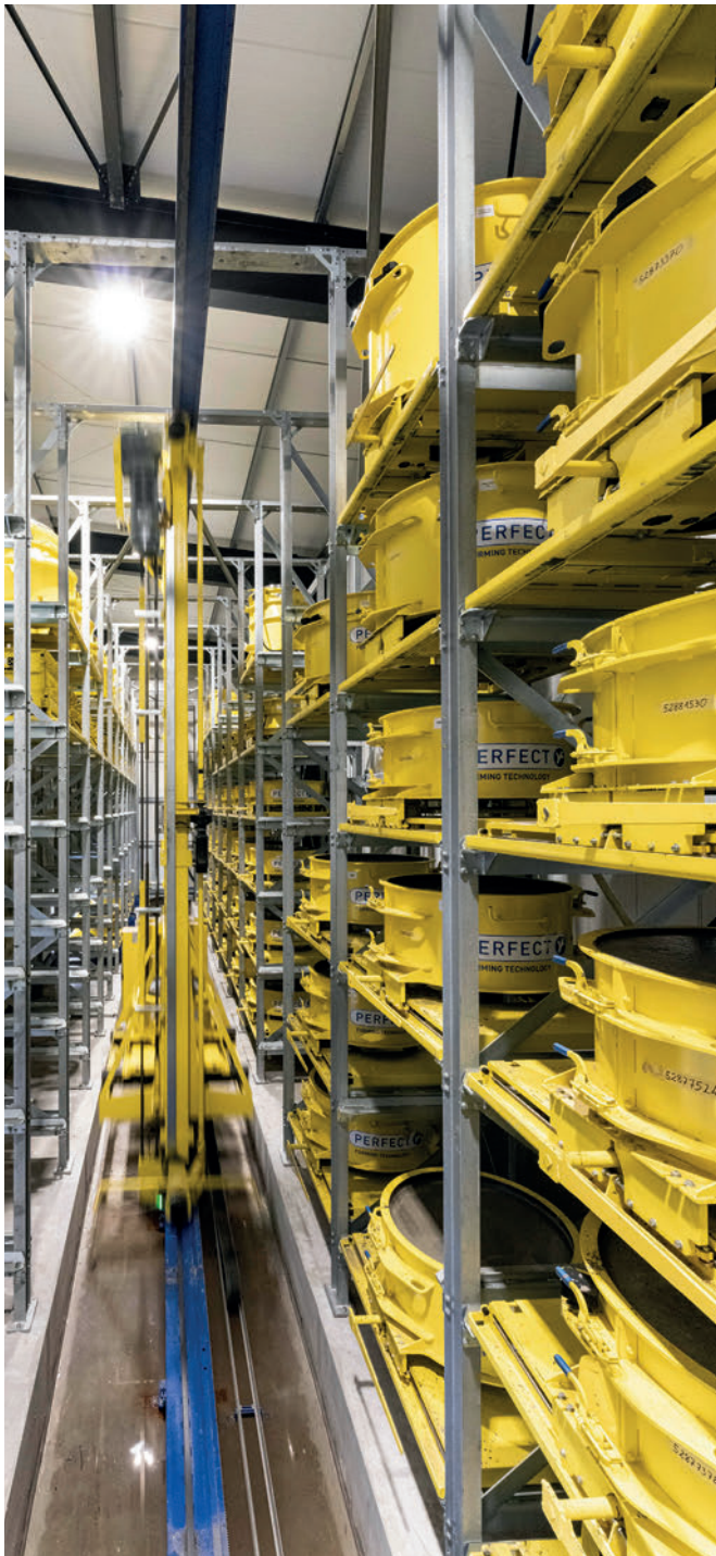
Almacén con estanterías como área de solidificación eficiente y compacta para productos endurecidos por encofrado
