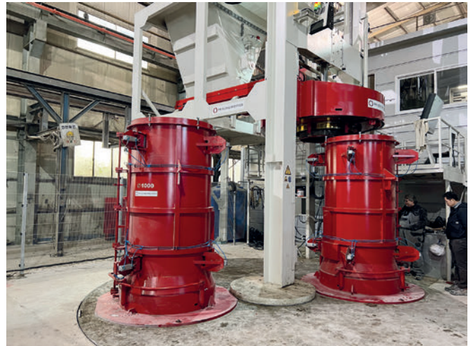
Producción de tubos con dos moldes
