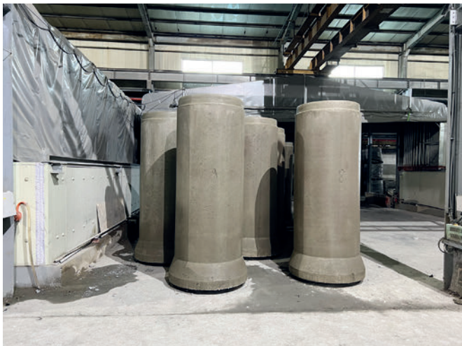
Entschalte Betonrohre DN 1000
