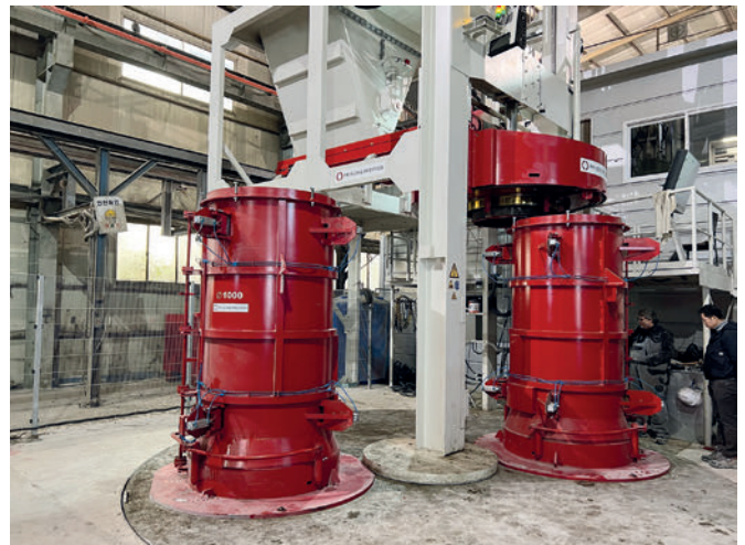
Rohrherstellung mit zwei Formen
