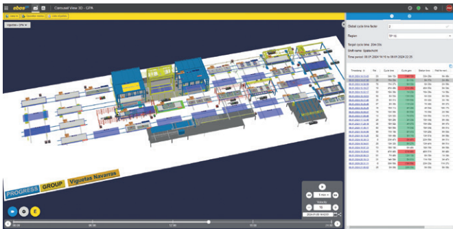
在 ebosyc 中，通过 GPA（图形性能分析器），可以实现三维全透明度
