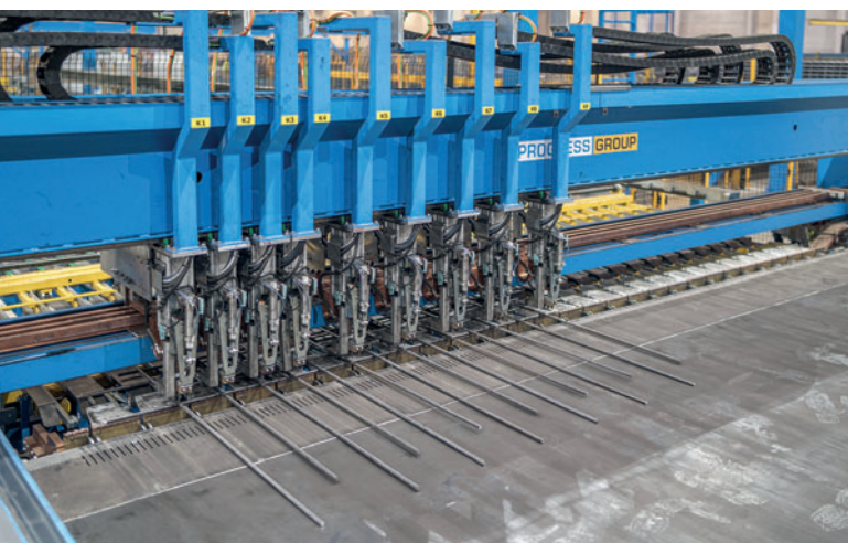
Новая сеткосварочная линия M-System с 9 сварочными головками обеспечивает гибкое производство арматурной сетки
