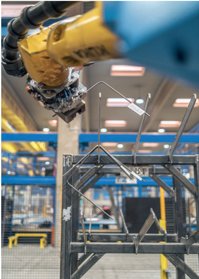
Роботы для съема автоматически устанавливают хомуты в заданное положение на транспортной стойке
