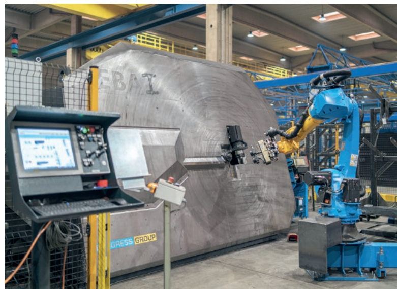
Trzy automatyczne giętarki strzemion EBA mogą obrabiać średnice od 6 do 16 mm. Jedna z maszyn posiada system gięcia 3D do produkcji strzemion trójwymiarowych.
