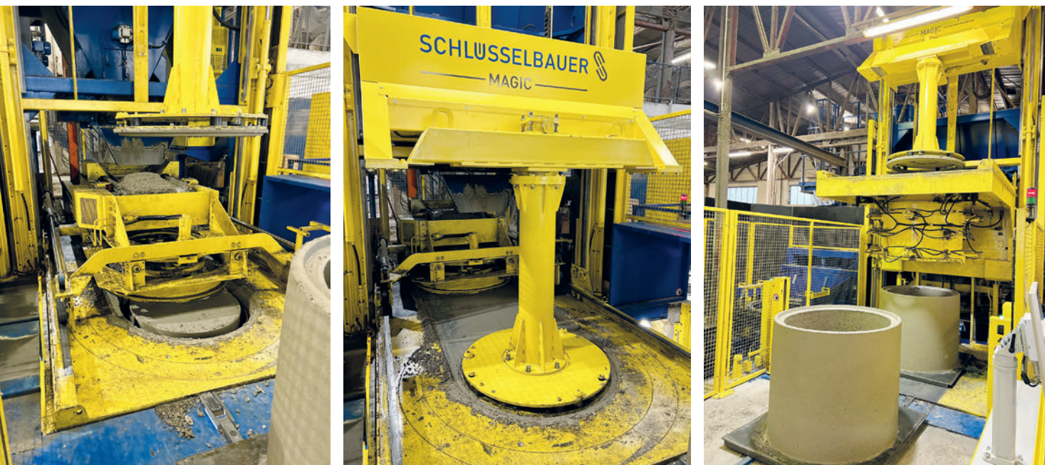
Produzione di un anello per pozzetto con l'impianto Magic 1501
