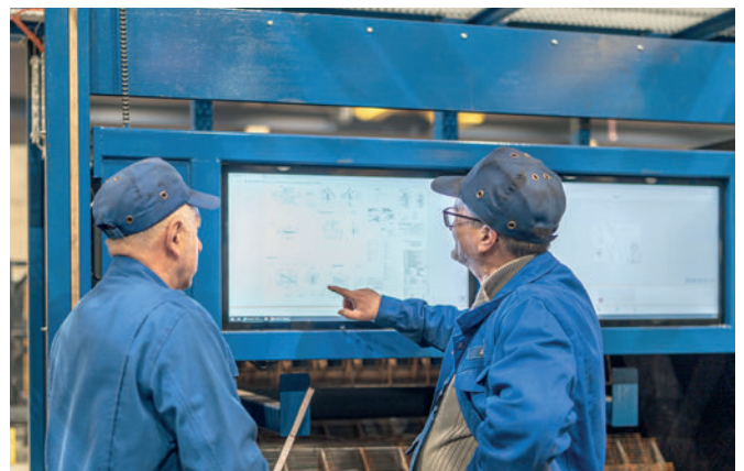
Les terminaux à écran facilitent le contrôle et la planification de la production par les employés et garantissent une production sans papier.
