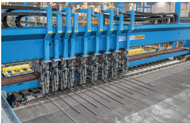
La nouvelle installation de soudage de treillis M-System assure une production flexible de treillis grâce à ses 9 têtes de soudage au total.
