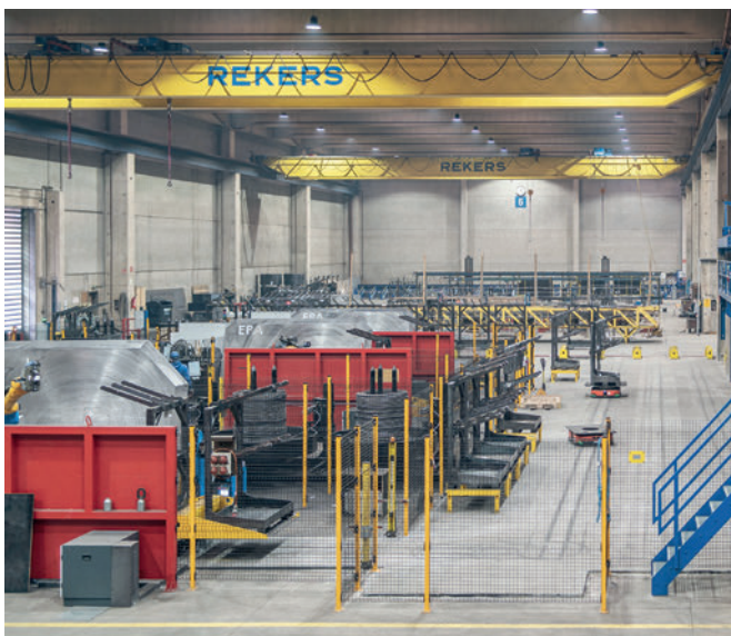
Au siège de Spelle, trois cadreuses, y compris la logistique automatisée, ont été mises en service.
