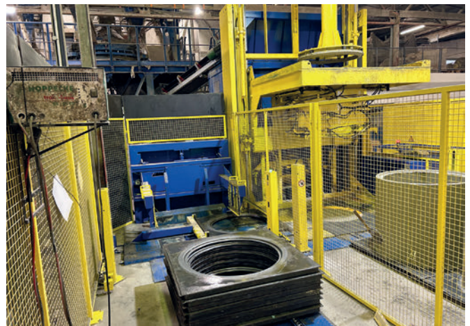
Colocación del anillo de refuerzo durante la producción del anillo para pozos
