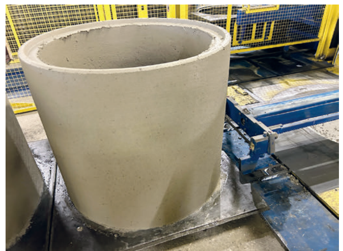
El nuevo producto se empuja dentro del encofrado inferior hacia fuera de la máquina
