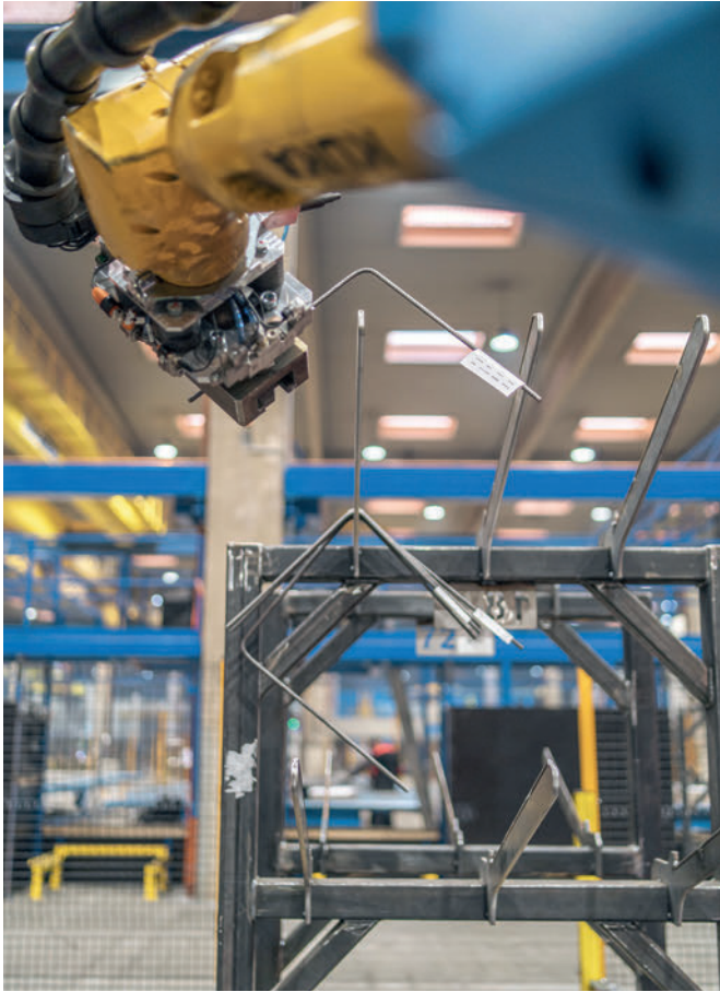
Los robots de recogida ubican los estribos automáticamente en la posición asignada sobre el bastidor de transporte.
