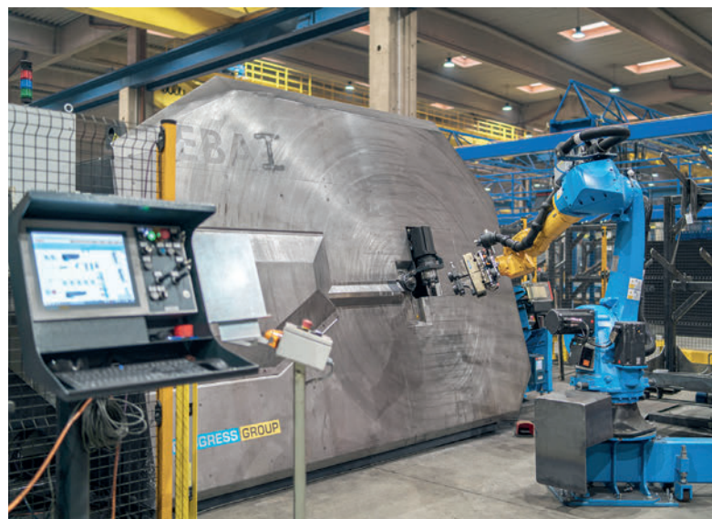
Las tres estribadoras automáticas EBA pueden abarcar diámetros de 6 a 16 mm. Una máquina dispone de un dispositivo de curvado 3D para la producción de estribos tridimensionales.
