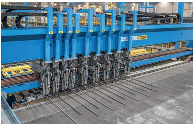
Die neue M-System-Mattenschweißanlage sorgt mit den insgesamt neun Schweißköpfen für eine flexible Mattenproduktion.
