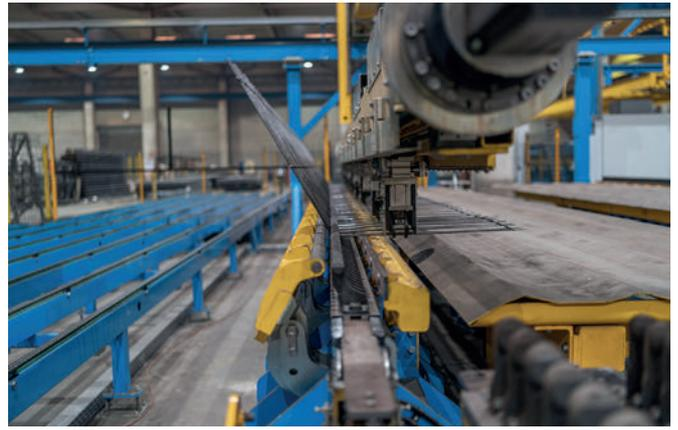
Das Balkenbiegesystem kann während der laufenden Produktion einen automatischen Wechsel der Biegematrizen vollziehen.
