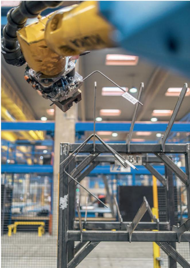
Die Entnahmeroboter platzieren die Bügel automatisch auf der zugewiesenen Position auf dem Transportgestell.
