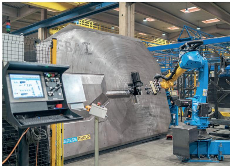
Die drei EBA-Bügelbiegeautomaten können Durchmesser von 6 bis 16 mm abdecken. Eine Maschine verfügt über eine 3D-Biegevorrichtung für die Produktion dreidimensionaler Bügel.
