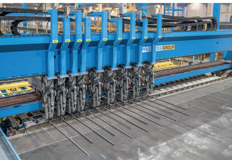
新型 M-System 网孔焊机共 9 个焊头，保证了网孔生产的灵活性
