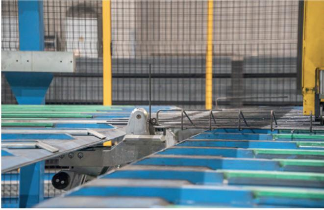
M-System 系统配备了几个单独的弯曲头，可以自动生产不同形状的支撑架
