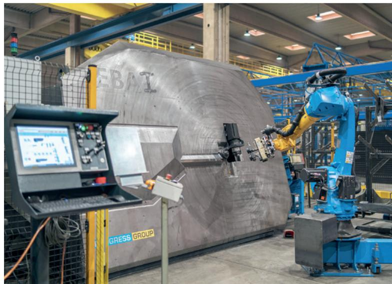
三台 EBA 自动箍条弯管机可覆盖 6 至 16 毫米的直径。一台机器具有三维弯曲装置，用于生产三维箍筋
