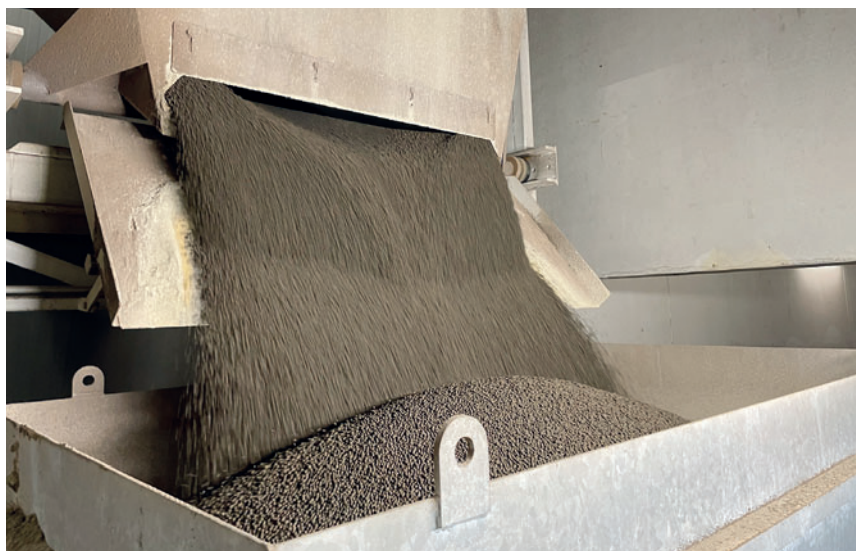
Питающий скиповый подъемник и весы над 10 камерами бункера
