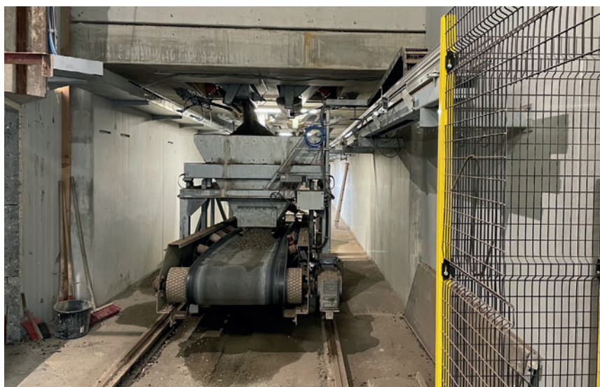
Специальные подвижные весы, расположенные под камерами бункера, передают взвешенные заполнители на разгрузочный ленточный транспортер
