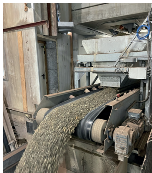
Специальные подвижные весы, расположенные под камерами бункера, передают взвешенные заполнители на разгрузочный ленточный транспортер
