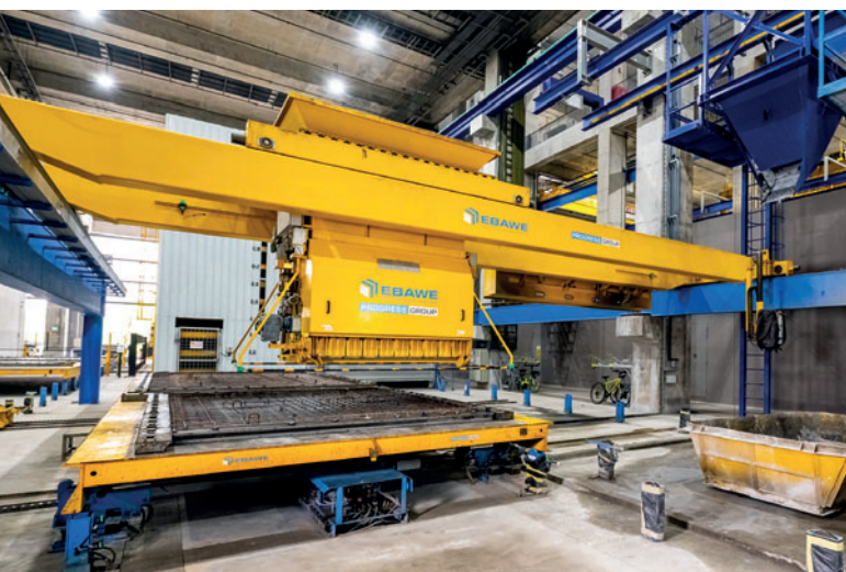
Бетонораздатчик выдает именно то количество бетонной смеси, которое необходимо для данного элемента в соответствии с планом, что снижает количество отходов
