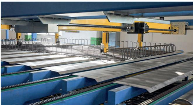
Полностью автоматизированная система гибки обеспечивает высокое качество арматурных каркасов
