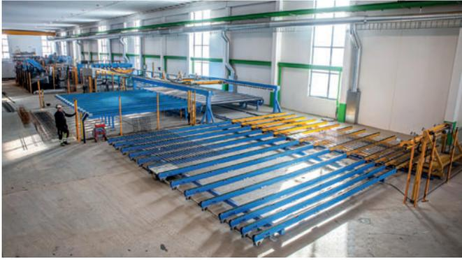
Сеткосварочная система M-System BlueMesh производит плоские и изогнутые армосетки в автоматическом режиме в соответствии с данными САПР
