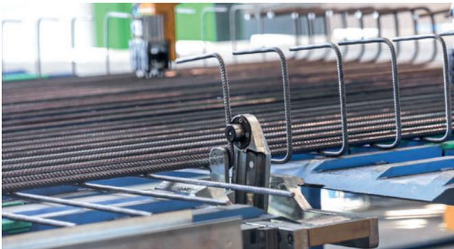
С помощью одинарных гибочных головок гибка проволоки осуществляется точно по плану без применения ручного труда
