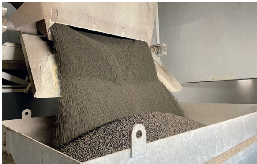
Kosz zasypowy i waga nad 10 komorami kruszywa.
