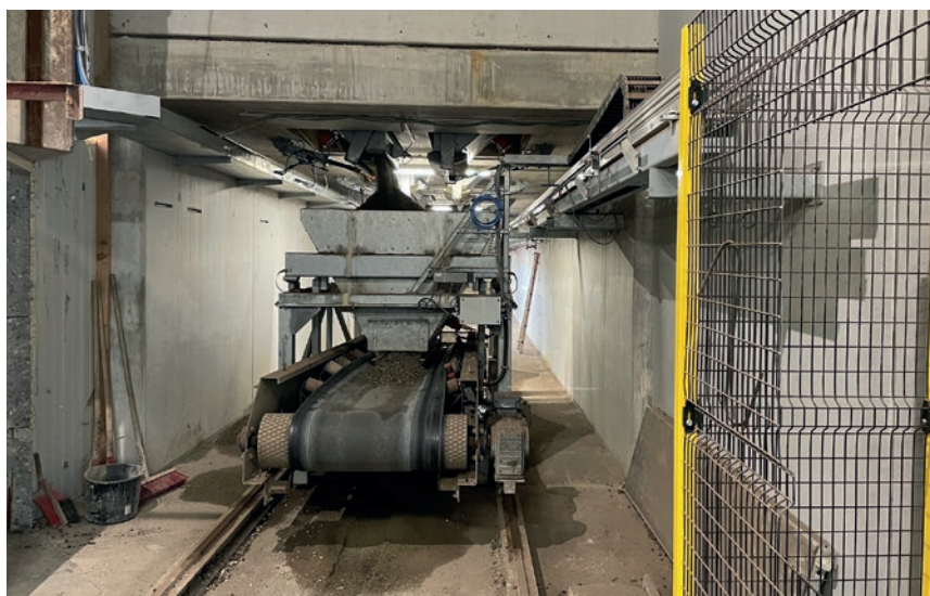
Specjalna ruchoma waga pod komorami zasobnika na kruszywo przekazuje naważone kruszywo na taśmociąg odbiorczy.
