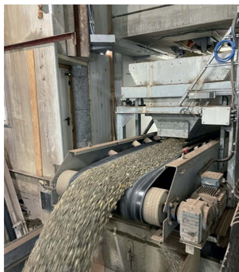
Specjalna ruchoma waga pod komorami zasobnika na kruszywo przekazuje naważone kruszywo na taśmociąg odbiorczy.
