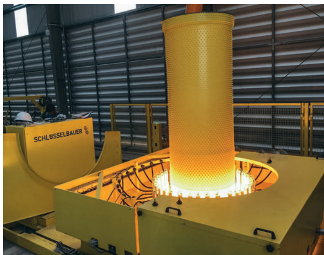
Formatura termoplastica del liner verso il giunto interno
