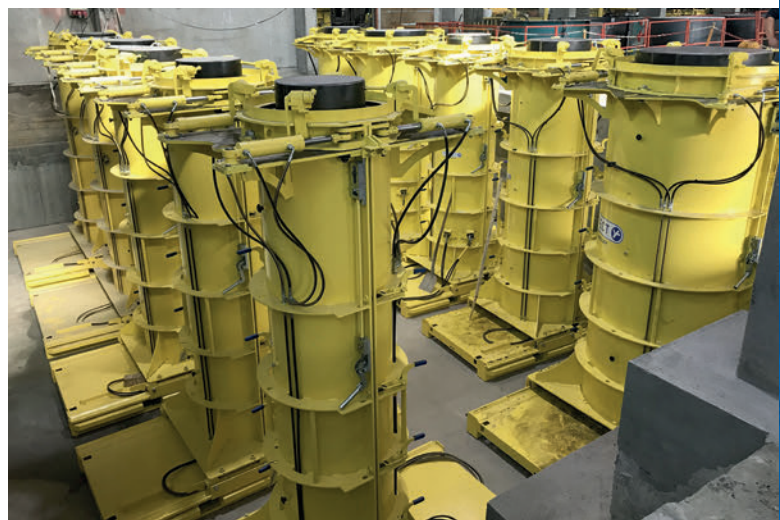
Produzione di tubi di spinta presso Beton Müller con stampi Perfect di Schlüsselbauer Technology
