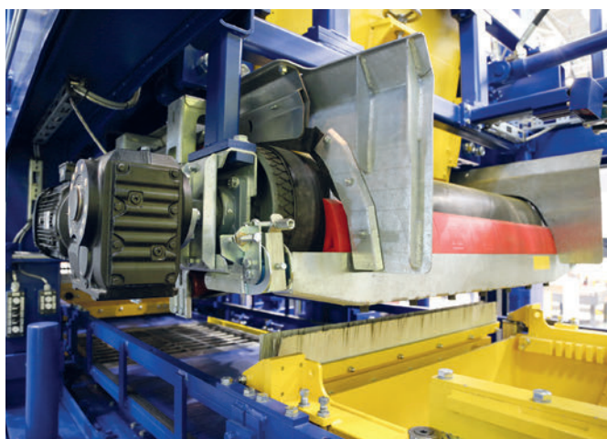
I nastri di dosaggio consentono il riempimento variabile ed ottimale del vagone di caricamento del calcestruzzo per lo strato interno e di rivestimento
