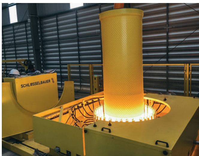
Formation par procédé thermoplastique de la partie « emboîtement » du revêtement
