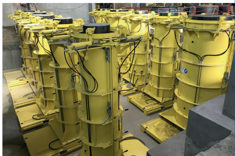
Production de tuyaux de fonçage chez Beton Müller dans les moules Perfect fournis par Schlüsselbauer Technology
