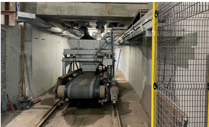
La cellule de charge spéciale, qui se déplace sous les compartiments de la trémie, transfère les granulats pesés vers une bande transporteuse.
