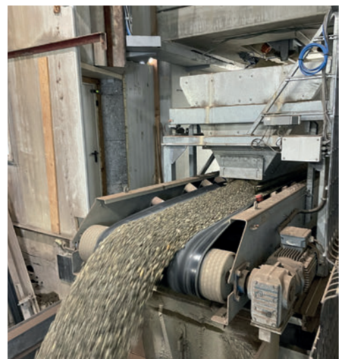
La cellule de charge spéciale, qui se déplace sous les compartiments de la trémie, transfère les granulats pesés vers une bande transporteuse.
