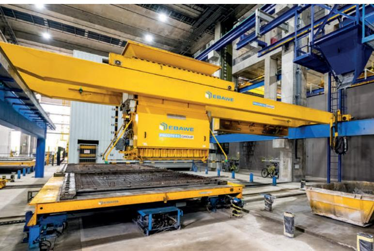
Le distributeur de béton fournit la quantité exacte de béton nécessaire pour le coulage de l'élément conformément au plan, réduisant du même coup les pertes.
