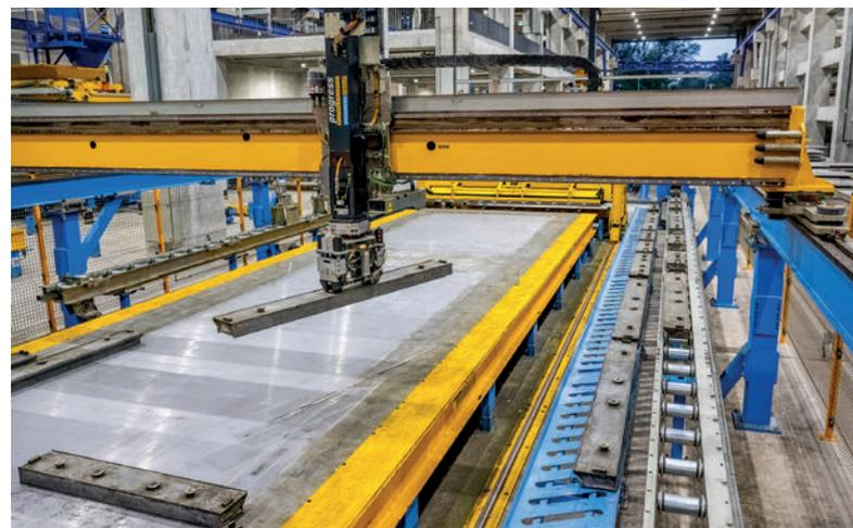
*Avec le robot de coffrage et de décoffrage Form Master, les panneaux sont placés et retirés en fonction des données de production fournies.*
