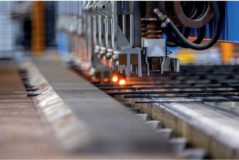
La ligne de soudage automatisée fabrique des treillis et des cages d'armature utilisés comme renforcement dans les éléments en béton.
