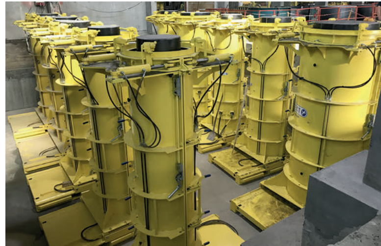
Producción de tubos para hincado en Beton Müller con moldes Perfect de Schlüsselbauer Technology
