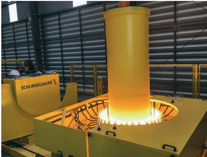
Moldeo termoplástico del revestimiento para manguito interior
