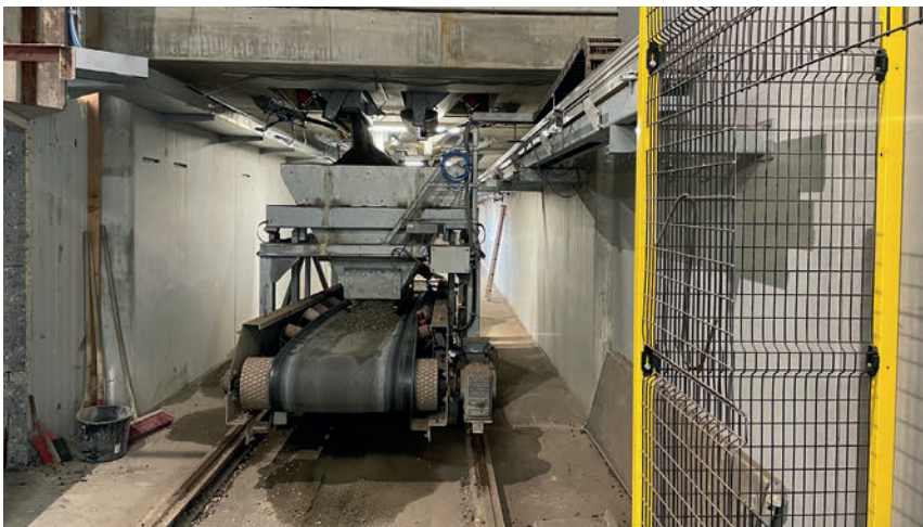
La balanza móvil especial situada debajo de las cámaras del silo entrega los áridos pesados a la cinta transportadora
