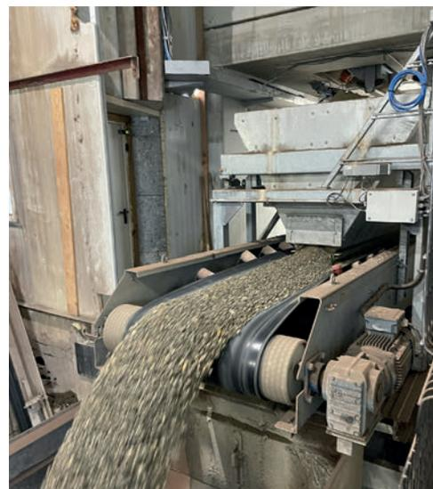
Die spezielle verfahrbare Waage unterhalb der Silokammern übergibt die verwogenen Gesteinskörnungen dann auf das Abzugsband.
