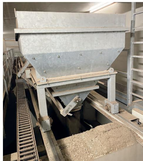
Beschickeraufzug und Waage oberhalb der 10 Silokammern
