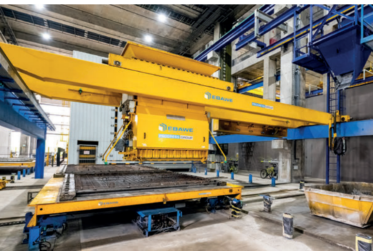
Der Betonverteiler liefert exakt die Betonmenge, die laut Plan für das jeweilige Element benötigt wird und so das Abfallvolumen verringert.
