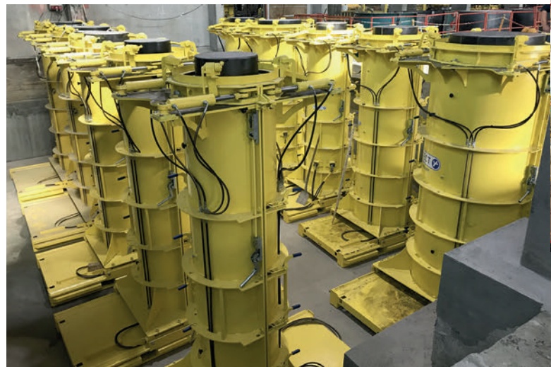
Produktion Vortriebsrohre bei Beton Müller mit Perfect-Formen von Schlüsselbauer Technology
