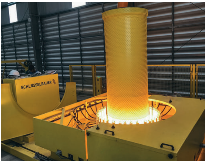
Thermoplastisches Umformen des Liners zur innenliegenden Muffe
