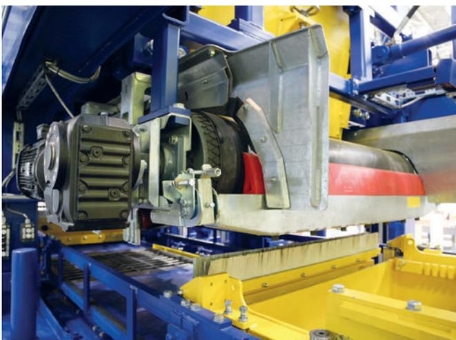
*Dosierbänder ermöglichen die variable und optimale Befüllung des Kern- und Vorsatzfüllwagens*
