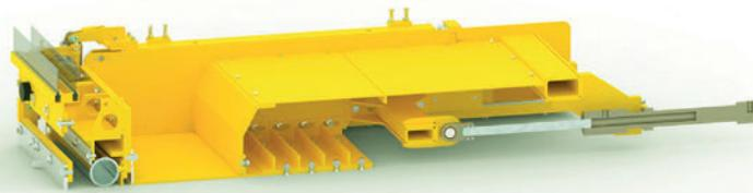
*Schnittansicht durch den Füllwagen mit Dosierschieber (offen und geschlossen)*
