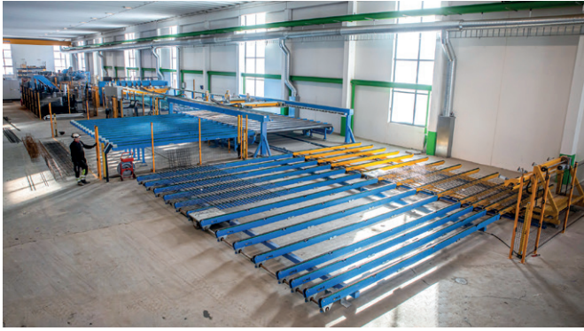
网格焊接设备 M-System BlueMesh 根据 CAD 数据自动处理平网和弯网的生产
