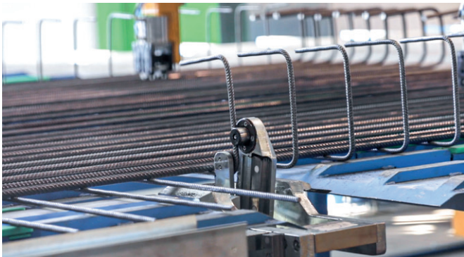
采用单弯头，可准确地按计划弯曲线材，无需人工
