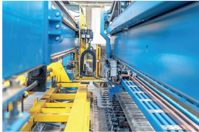
Возможность сварки продольной арматуры как сверху, так и снизу – инновационная технология, разработанная для Prefabbricati LP
