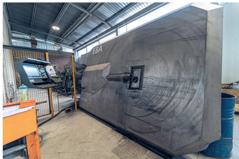
Автоматический станок EBA для гибки арматурных хомутов позволяет изготавливать хомуты различных форм и размеров
