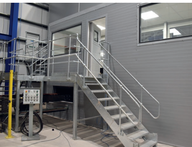
Unikalne rozwiązania okienne pozwalają na redukcję hałasu bez straty widoczności na linii produkcyjnej i do wnętrza maszynowni.
