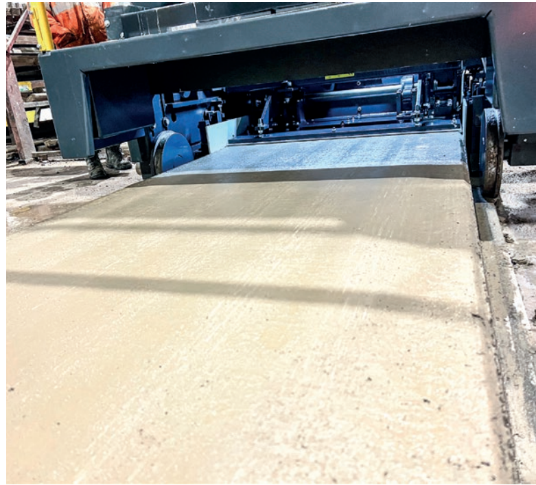
Mieszanka betonowa jest zagęszczana bezpośrednio na torze produkcyjnym i pozostaje na nim aż do stwardnienia.
