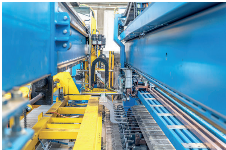
La possibilità di saldare le barre longitudinali sia sopra che sotto è una novità sviluppata per la Prefabbricati LP.
