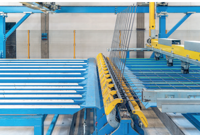
La macchina è dotata di un sistema flessibile di piegatura delle reti.
