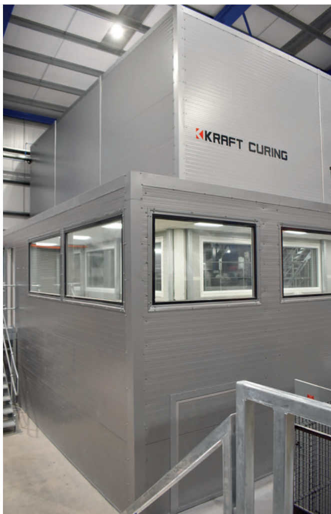
L'extérieur de la salle de contrôle et de l'encoffrement acoustique, vu depuis l'usine.
