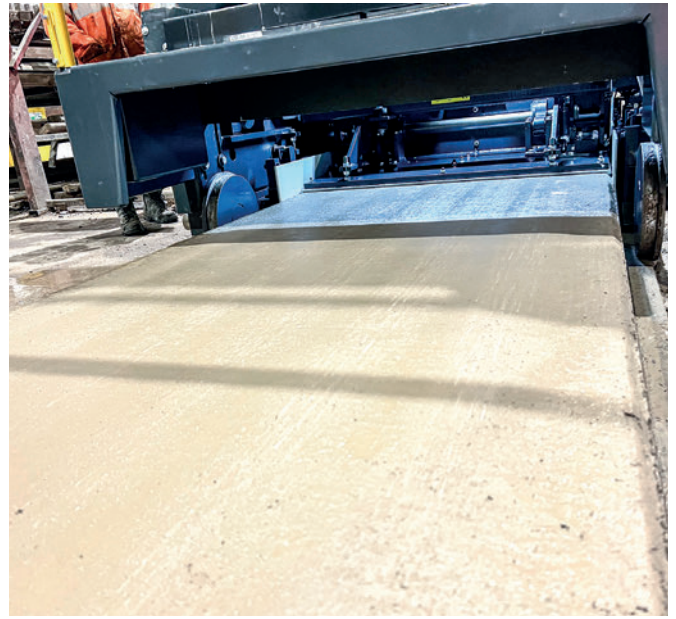
Le béton est pressé directement dans le banc de production et reste derrière la machine pour le durcissement.
