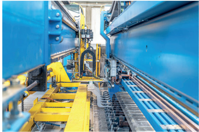
La possibilité de souder les barres longitudinales aussi bien en haut qu'en bas est une innovation développée pour Prefabbricati LP.
