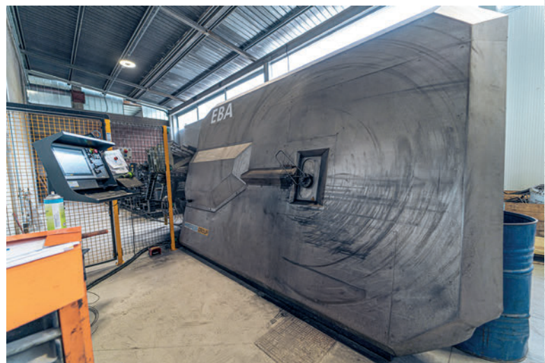
La cadreuse EBA produit des cadres de différentes formes et tailles.
