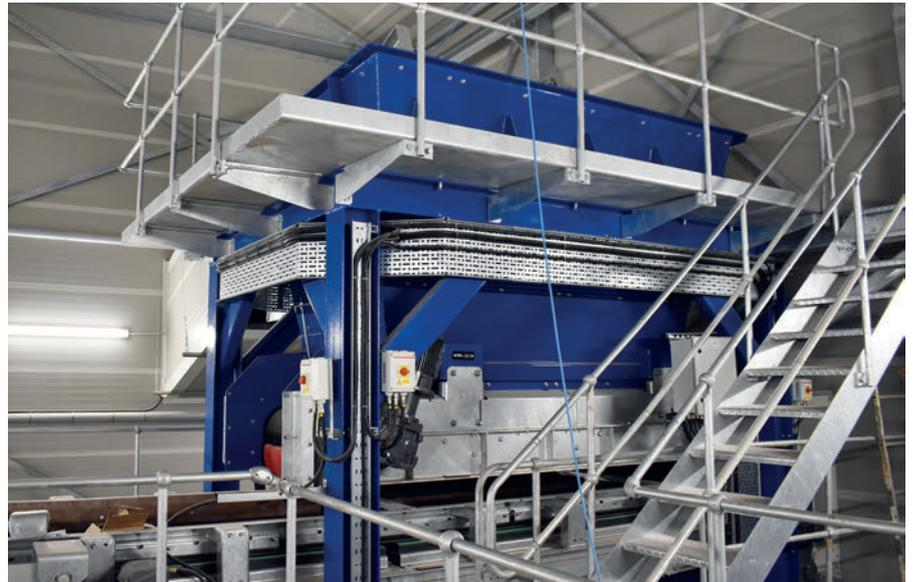
La máquina bloquera Columbia, modelo 1600, se encuentra en una sala de máquinas con aislamiento acústico
