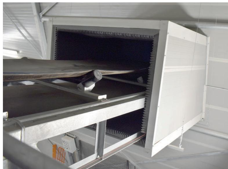
*Todos los túneles de entrada y salida se han aislado acústicamente con dos capas, con el fin de reducir al máximo posible la carga acústica dentro de la zona de producción*
