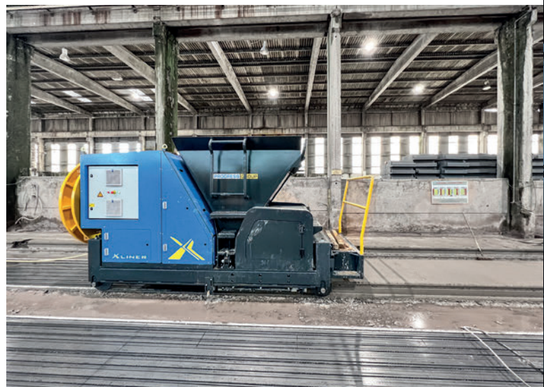
Las nuevas X-Liner funcionan de forma completamente automática, y la construcción de las máquinas facilita la reparación y la limpieza. Creagh puede reducir su esfuerzo, su volumen de residuos y sus tiempos de producción
