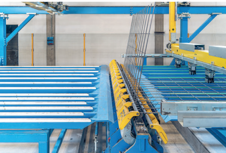
La instalación está equipada con un sistema de curvado de mallas flexible.
