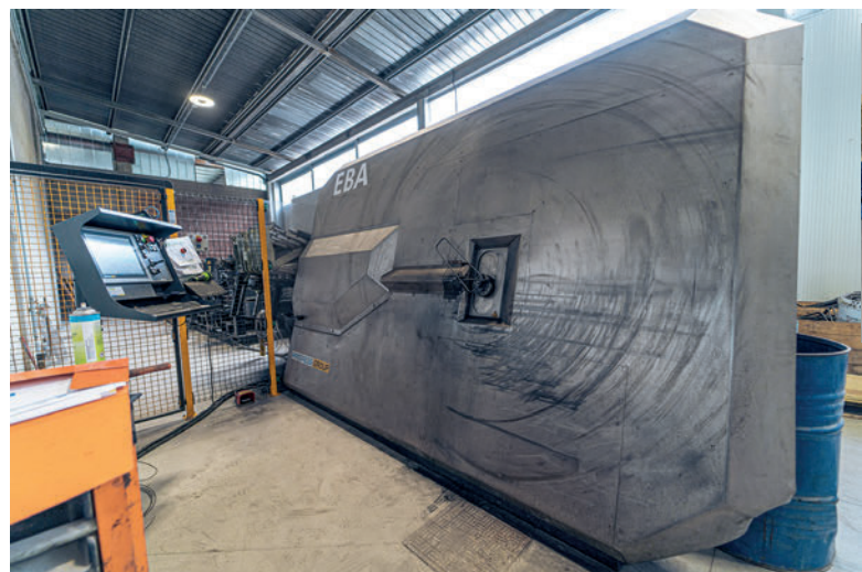
La estribadora automática EBA produce estribos de diferentes formas y tamaños.
