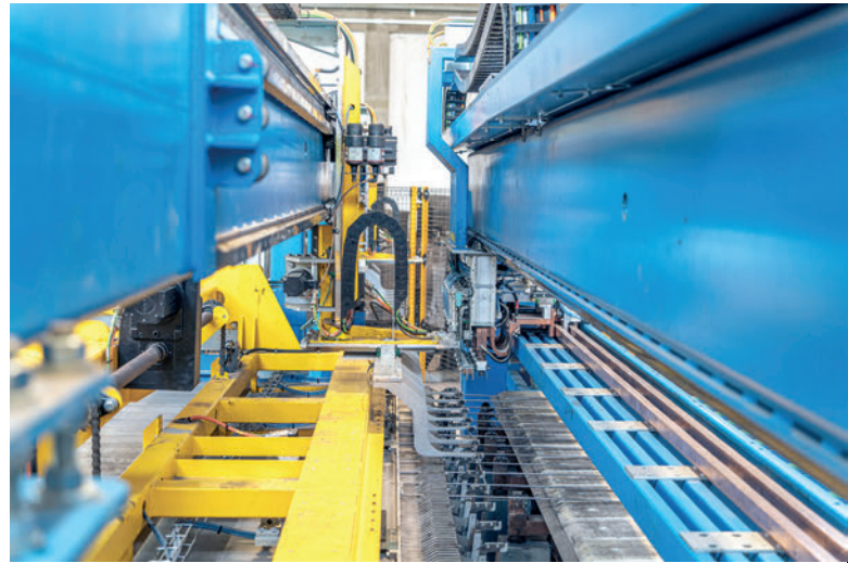
Die Möglichkeit, Längsstäbe sowohl oben als auch unten zu verschweißen, ist eine Innovation, die für Prefabbricati LP entwickelt wurde.
