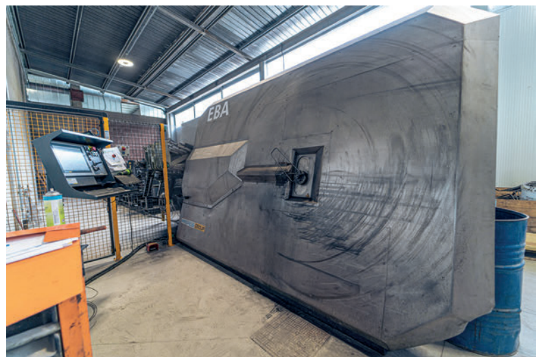
Der Bügelbiegeautomat EBA stellt Bügel in verschiedenen Formen und Größen her.
