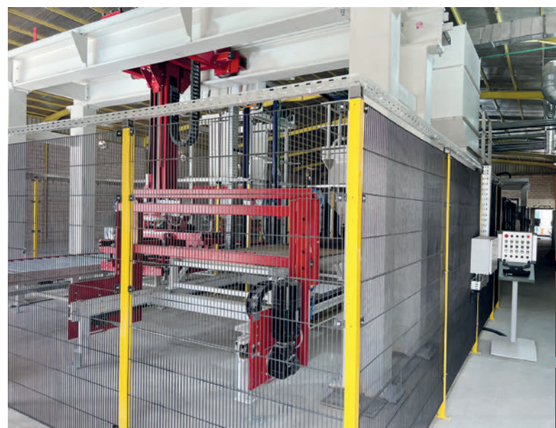
Sicherheitsbereich an der Aufgabe zum Lagenstapler
